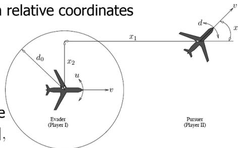
$$\dot{x} = \frac{d}{dt} \begin{bmatrix} x_1 \\ x_2 \\ x_3 \end{bmatrix} = \begin{bmatrix} -v + v \cos x_3 + ux_2 \\ v \sin x_3 - ux_1 \\ d - u \end{bmatrix} = f(x, u, d)$$
