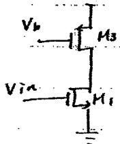
$$Av = -g_{m_1} \left( r_{o_1} // r_{o_3} \right) \rightarrow 0 \text{ if } \lambda = 0$$
